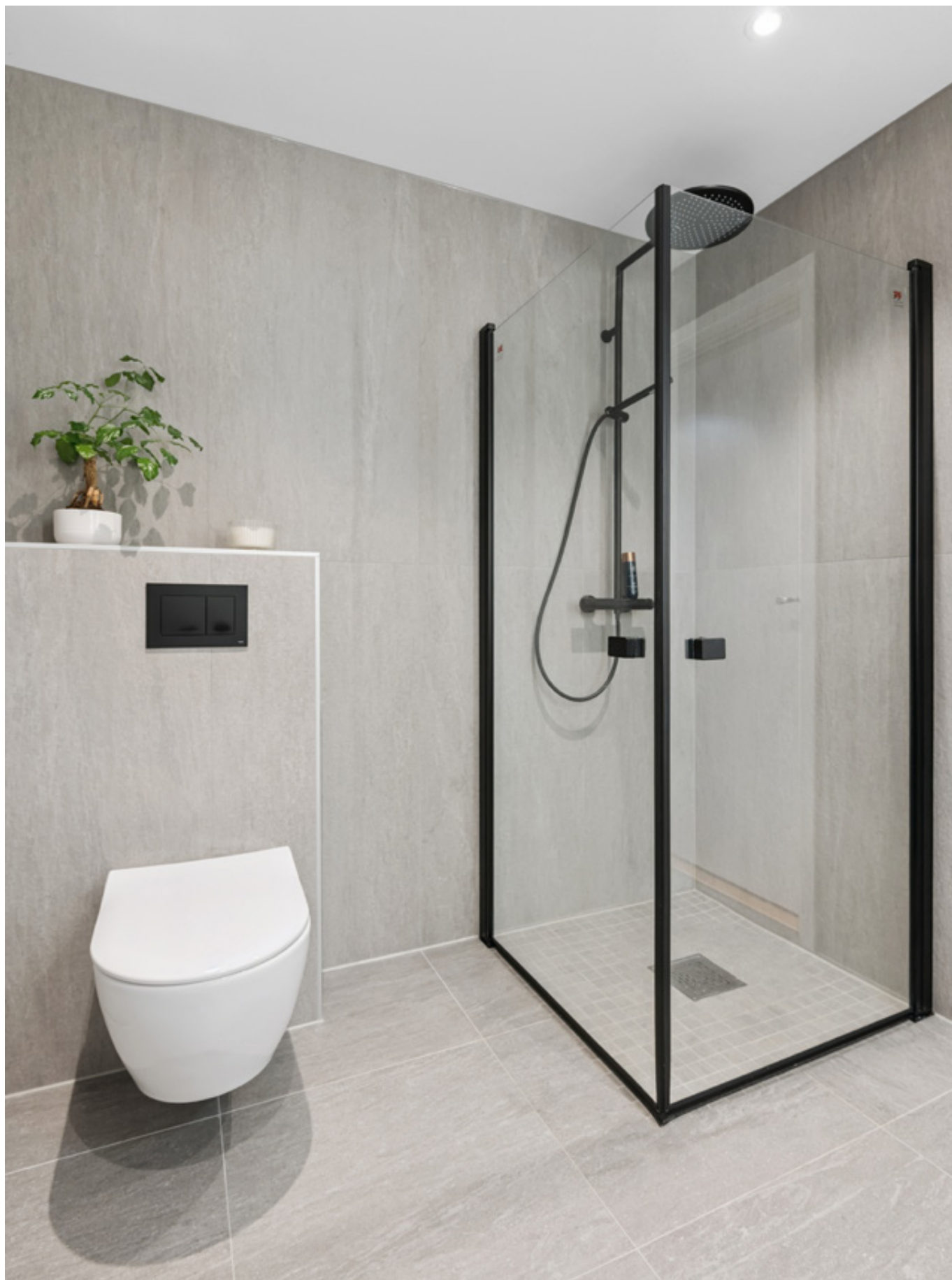
Dusjhjørne med innfellbare glassdører og nedfelt dusjgruve for et stilrent uttrykk.
