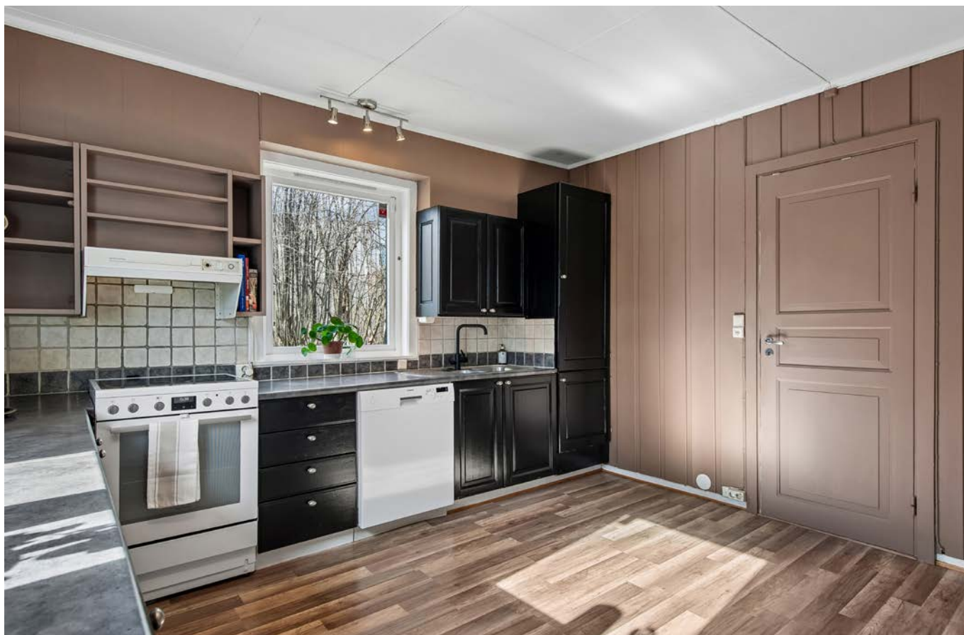
Kjøkkenet har mekanisk avtrekk, og det ble installert en ny kurs til komfyr med komfyrvakt i 2020.
