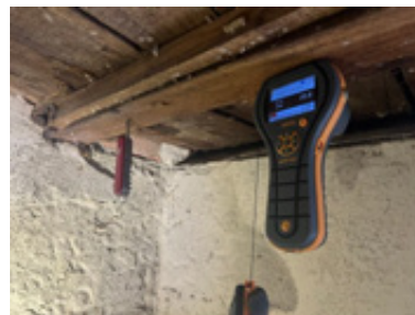
I det sør/østre hjørne ble det målt skadelig fukt.
