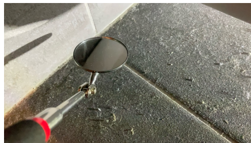
Lekkasjedeteksjon for vegghengt toalett.
