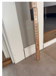
Bildet viser laveste nivå fra horisontalplanet over lang målelengde i stue/kjøkken.
