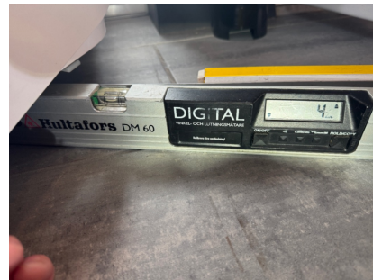
Bildet viser fall bort fra sluk på 4 mm/m (motfall).
