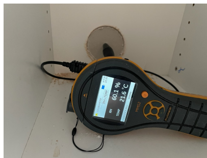
Bilde viser måling av luftfuktighet (RF)
