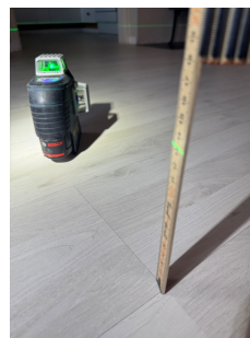
Bildet viser laveste nivå fra horisontalplanet over kort målelengde i stue/kjøkken.
