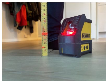
Bilde viser måling av gulv ved laser.
