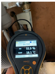
Bilde viser måling av luftfuktighet (RF)
