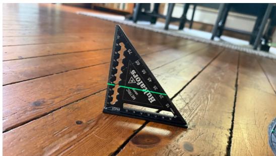
Bildet viser en tilfeldig stikkprøve for å kontrollere skjevheter i gulvet.
