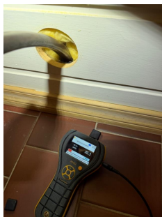
Bildet viser måling av fuktinnhold i treverk/bunnsvill inni utforet kjellervegg. Målingen er litt høy.
