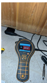
Måling direkte i treverk som henger på grunnmur under trapp viser fuktmåling 20,2%
